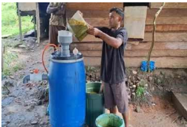
Gambar 7. Proses memasukkan kotoran ke dalam digester untuk di lakukan fermentasi
