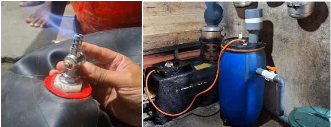
Gambar 8. Uji coba nyala api dari gas metana yang dihasilkan dari proses fermentasi menggunakan teknologi biogas
