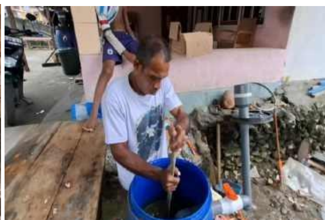
Gambar 7. Proses memasukkan kotoran ke dalam digester untuk di lakukan fermentasi
